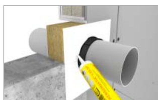
Verschließen des Ringspalts mit HENSOMASTIK® 5 KS SP
