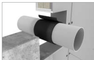
Wicklung um das brennbare Rohr, mittig zur Mineralwollplatte, je 20mm überstehend
