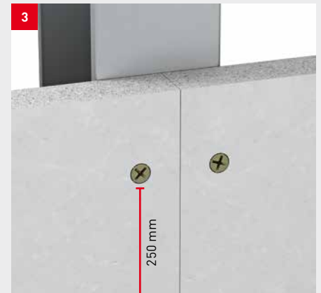
Einlagige Konstruktion – Befestigung in Unterkonstruktion
