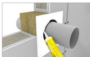
Obturation de l'interstice annulaire avec HENSOMASTIK® 5 KS SP
