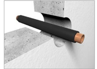
Ringspalt wird mit Mineralwolle, Rohdichte ≥ 90 kg/m³, und einer beidseitigen 15 mm dicken Schicht **HENSOTHERM® Spachtel - universal** - verschlossen.
